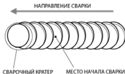
Рис. 11.2.2. Начало сварки при смене электрода.
