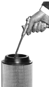
Рис. 10.3 Очистка фильтрующего элемента воздушного фильтра
