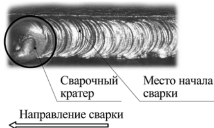
Рис. 9.2. Начало сварки при смене электрода.
